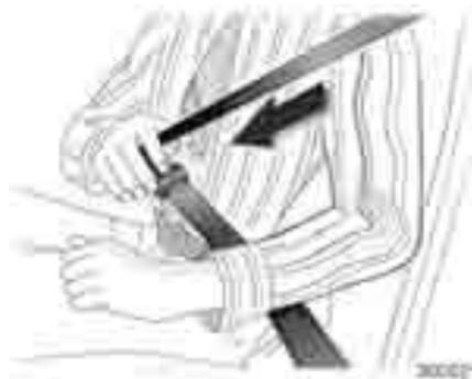
Потяните за ремень, не допуская скручивания, протяните вдоль тела и защелкните язычок ремня в замке. Во время движения не допускайте ослабления натяжения ремня.
