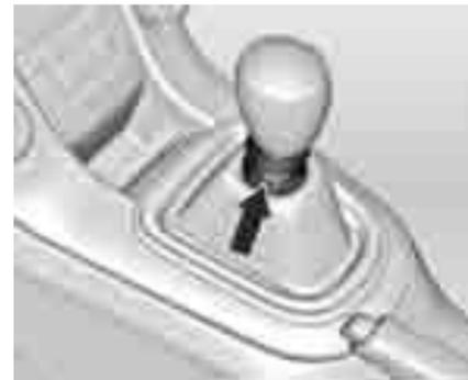
Для включения передачи заднего хода на неподвижном автомобиле потяните кольцо на рычаге переключения передач и включите передачу.
