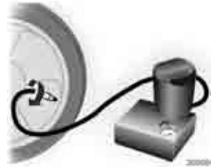
6. Отверните колпачок ниппеля поврежденной шины.
