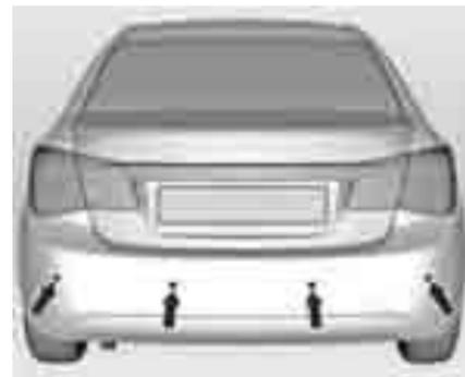
Система помощи при парковке облегчает парковку автомобиля путем измерения расстояния от автомобиля до расположенных сзади препятствий и подачи звуковых сигналов. Однако это не в коей мере не снимает с водителя ответственность за маневрирование при постановке автомобиля на стоянку.
