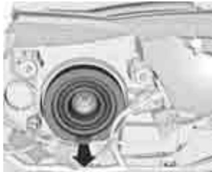
2. Снимите защитную крышку.
