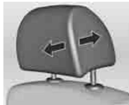
Для перемещения по горизонтали вытяните подголовник вперед и зафиксируйте в одном из трех положений. Для возврата в крайнее заднее положение вытяните его вперед полностью и отпустите.
