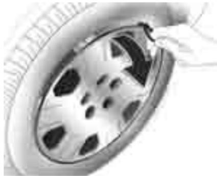
1. Подцепите колпачки колесных гаек отверткой и снимите их. Снимите колесный колпак с помощью крюка. Автомобильный инструмент  $\diamond$  152.
