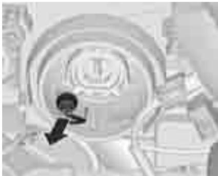
3. Выньте патрон лампы габаритного фонаря из отражателя.
