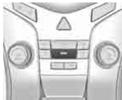
Чтобы установить требуемое значение, нажмите кнопку **MODE** один или несколько раз. На дисплее Info-Display отображается режим распределения воздуха.
