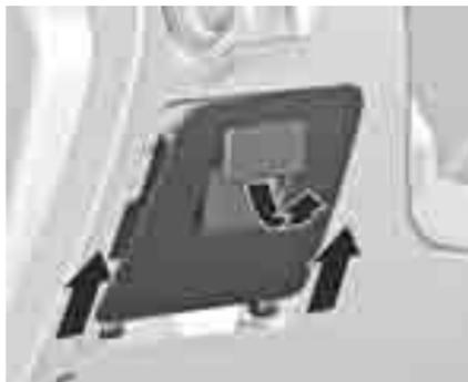
Коробка предохранителей находится за отделением для хранения инструментальной панели.
