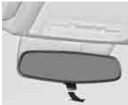
Для уменьшения риска ослепления измените положение рычага в нижней части зеркала.
