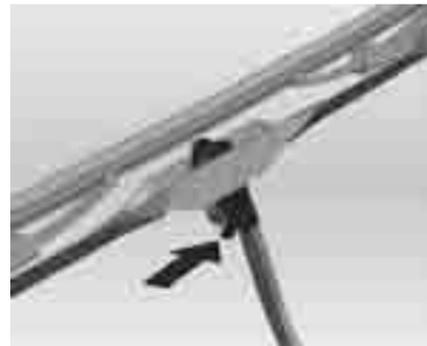
Поднимите кронштейн стеклоочистителя. Нажмите отжимной рычаг и снимите стеклоочиститель.
