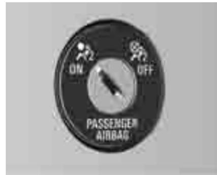
Система подушек безопасности переднего пассажира отключается с помощью выключателя, расположенного сбоку на панели приборов
