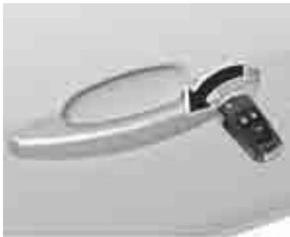
Откройте дверь водителя вручную поворотом ключа в замке. Включите зажигание и нажмите кнопку центрального замка
