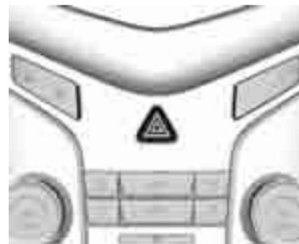
Включается с помощью кнопки
