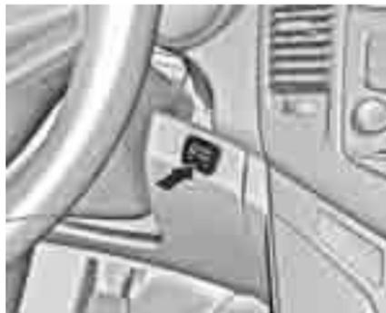
Нажмите кнопку **Start/Stop**. Включается зажигание. В кнопке загорается желтый светодиод, подтверждающий включение зажигания. Электронный иммобилайзер выключается.
