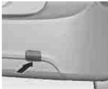
Снимите крышку, надавив на отметку и вытащив ее из зацепления.
