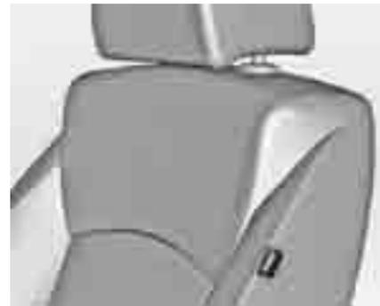
Система боковых подушек безопасности состоит из подушек, установленных в спинках передних сидений. Эти подушки можно определить по надписи **AIRBAG**.
