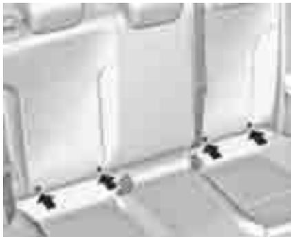
Закрепите разрешенные для применения в этом автомобиле системы безопасности детей ISOFIX в крепежных скобах.
