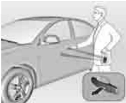
При наличии электронного ключа просто потяните ручьятку двери, автомобиль будет разблокирован, и дверь откроется. Чтобы открыть заднюю дверь, нажмите кнопку под молдингом.
