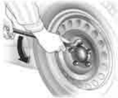
2. Разложите колесный ключ и установите его, убедившись, что он стоит надежно, затем ослабьте каждую колесную гайку на пол-оборота.
