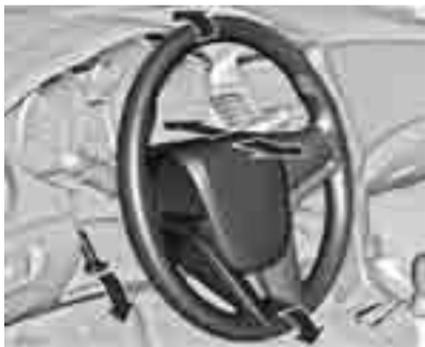
Отпустите рычаг, отрегулируйте рулевое колесо, затем зафиксируйте рычаг и убедитесь, что он полностью заблокирован. Выполняйте регулировку только на стоящем автомобиле с разблокированным рулевым колесом.
