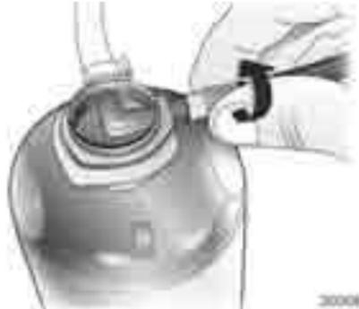
4. Накрутите воздушный шланг компрессора на штуцер баллона с герметиком.
