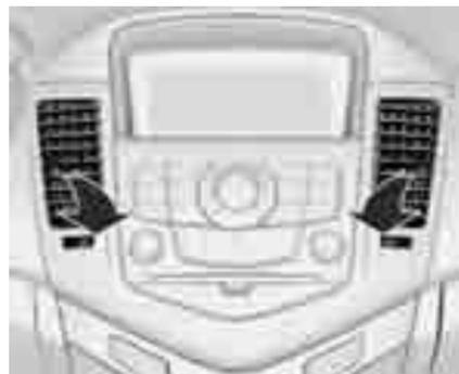
Чтобы закрыть отверстие, поверните регулировочный маховичок в положение ☒.
