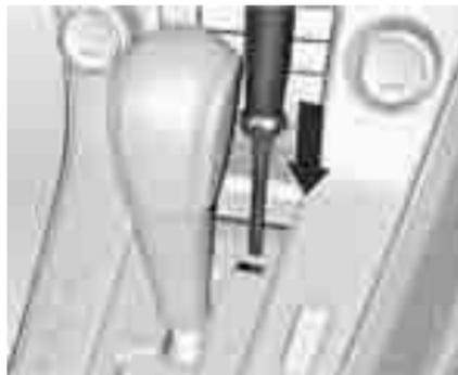
3. Вставьте отвертку в отверстие как можно глубже и выведите рычаг селектора из положения **P**. Если снова перевести селектор в положение **P** то он будет заблокирован повторно. Устраните причину потери напряжения питания на станции техобслуживания.
