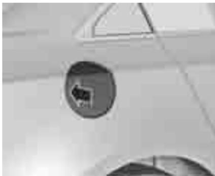
Заправочный лючок открывается только если замки автомобиля разблокированы. Откройте крышку топливозаправочной горловины, нажав на нее.
