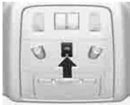
Отключите контроль салона и наклона автомобиля, если в автомобиле остался пассажир или животное, так как для контроля салона используется мощный ультразвуковой сигнал, а также при транспортировке автомобиля на пароме или поезде, чтобы избежать срабатывания сигнализации при перемещении автомобиля.
