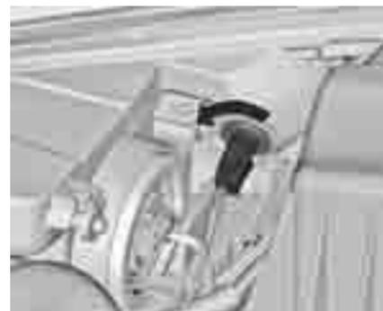
1. Поверните патрон лампы против часовой стрелки и освободите его.
