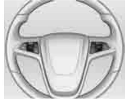
С помощью установленных на рулевом колесе органов управления можно управлять информационно-развлекательной системой и круиз-контролем.
