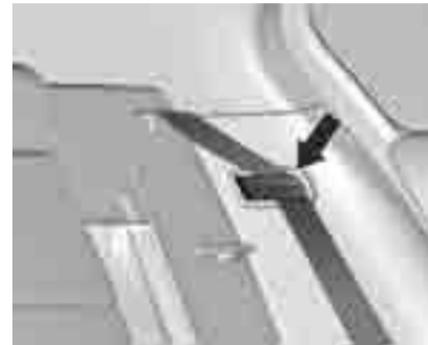
Установите спинки сидений в вертикальное положение и извлеките ремни безопасности из гнезд хранения с направляющими.
