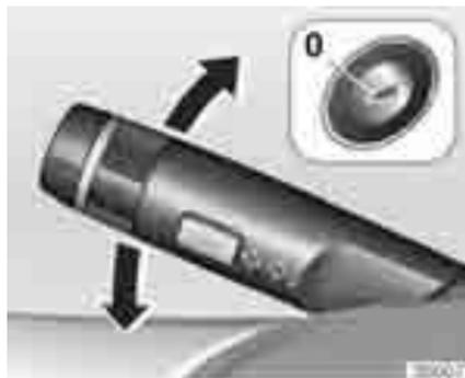
При парковке автомобиля можно включить передние и задние габаритные огни с одной стороны:
