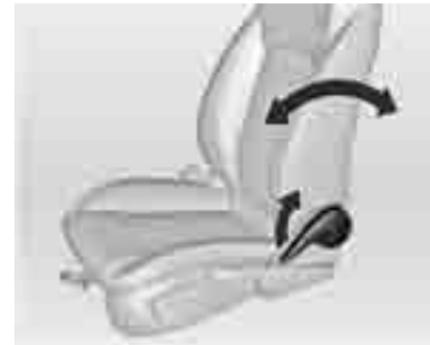
Потяните рычаг, отрегулируйте наклон и отпустите рычаг. Сиденье должно зафиксироваться в новом положении с характерным щелчком. Во время регулировки не откидывайтесь на спинку.
