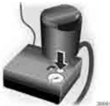
Если заданное давление шины не будет достигнуто в течение 10 минут, извлеките ремонтный комплект для шин. Переместите автомобиль так, чтобы колесо совершило один оборот. Снова установите комплект для ремонта шин и продолжайте накачивать шину еще 10 минут. Если требуемое давление все равно не устанавливается, шина повреждена очень сильно. Обратитесь за помощью на станцию техобслуживания.
