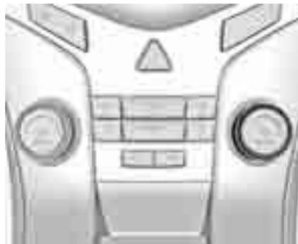
Поверните правую ручку регулятора. Выбранная скорость вентилятора отображается на дисплее в виде числа.
