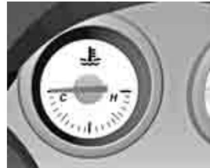
Отображает температуру охлаждающей жидкости двигателя.
