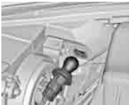
2. Слегка втолкните патрон лампы в гнездо, поверните против часовой стрелки, снимите и замените лампу.
