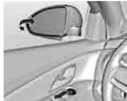
Поверните выключатель в положение **0** и нажмите на рычаг выключателя сверху вниз. При этом оба наружных зеркала складываются.
