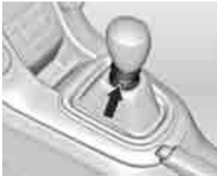
Задний ход: при неподвижном автомобиле выжмите сцепление, потяните за кольцо на рычаге селектора и включите передачу.
