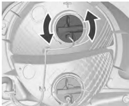
4. Поверните патрон лампы против часовой стрелки.
