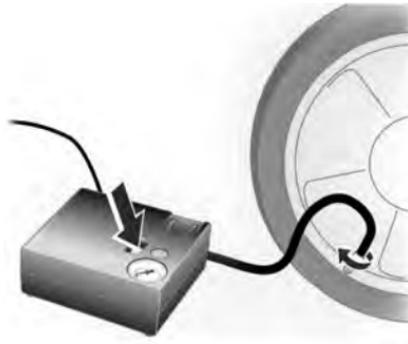
17. Сразу же продолжите движение, чтобы герметик смог равномерно распределиться по шине. Примерно через 10 км (но не позднее чем через 10 минут) остановитесь и проверьте давление в шине. Для этого наверните воздушный шланг компрессора непосредственно на вентиль шины и компрессор. При давлении больше 1,3 бар доведите давление до требуемого значения (около 2,4 бар). Повторяйте процедуру (№ 17) до прекращения падения давления.
