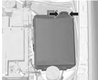
Блок предохранителей находится в моторном отсеке.
