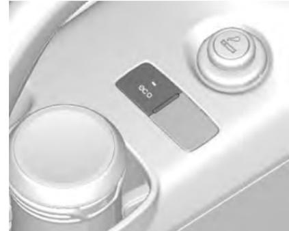
Чтобы принудительно отключить систему автоматической остановки и пуска двигателя, нажмите клавишу **eco**.
