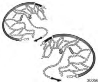
Допускается установка колесных цепей только на передних колесах (только на шины 14, 15, 16 дюймов).
