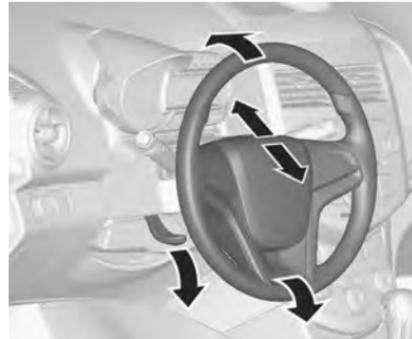
Освободите рычаг, отрегулируйте рулевое колесо, затем зафиксируйте рычаг и убедитесь, что он полностью заблокирован.
