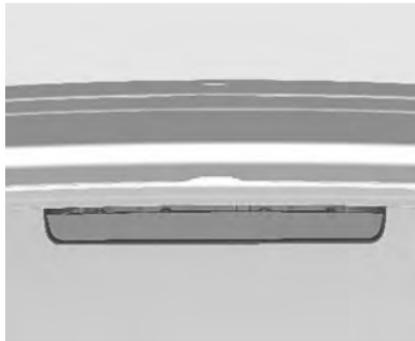
Если верхний центральный сигнал торможения не действует, обратитесь на станцию техобслуживания для проверки.
