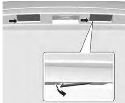
1. Извлеките фонарь с помощью отвертки.
