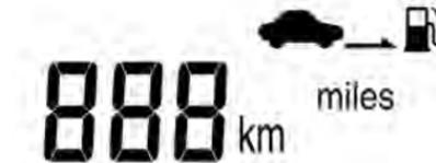
В этом режиме отображается примерное расстояние, которое автомобиль может проехать до полного опустошения топливного бака.
