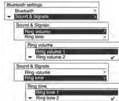
Для настройки мелодии и громкости звонка при использовании Bluetooth выберите **Sound & Signal** (Звук и сигнал) при помощи кнопки **MENU** и ручки управления **TUNE**, а затем установите нужные параметры кнопкой **MENU**.
