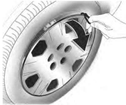
1. Подцепите колпак колеса отверткой и снимите его.
