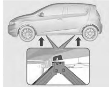
3. Вращая рукоятку домкрата, слегка приподнимите подъемную головку и установите домкрат вертикально в месте, отмеченном полукругом.
