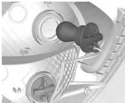
5. Извлеките патрон лампы. Слегка втолкните патрон лампы в гнездо, поверните против часовой стрелки, снимите и замените лампу.
