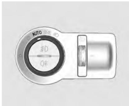
Если включено автоматическое управление освещением, внешние осветительные приборы и подсветка панели приборов включаются автоматически при слабой наружной освещенности.
