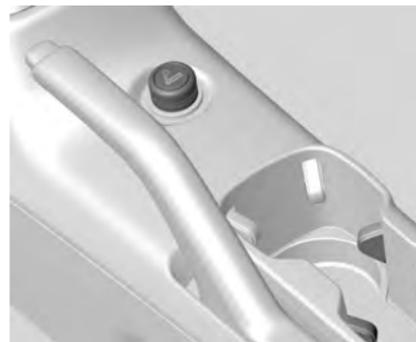
Для включения прикуривателя поверните ключ зажигания в положение АСС или ON и нажмите прикуриватель до упора.
