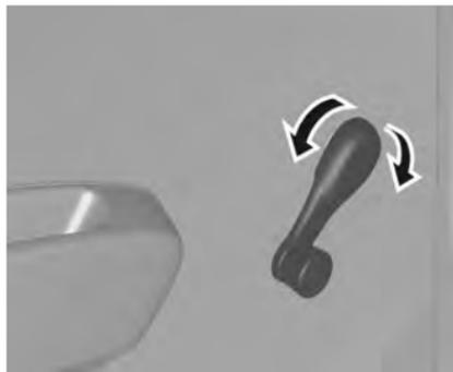
Дверные стекла опускаются и поднимаются с помощью ручек стеклоподъемников.
