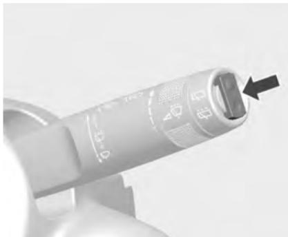
Для включения заднего стеклоочистителя нажмите на переключатель на конце рычага.
