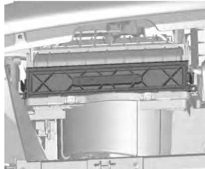
2. Снимите крышку фильтра, отвинтив винты с обеих сторон крышки.
