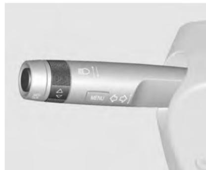
Для управления бортовым компьютером поверните регулировочное колесико на рычажке указателя поворота.
