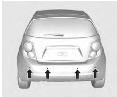
Система помощи при парковке облегчает парковку автомобиля, измеряя для этого расстояние между автомобилем и находящимися сзади препятствиями и выдавая слышимый в салоне звуковой сигнал. Однако это не в коей мере не снимает с водителя ответственность за постановку автомобиля на
