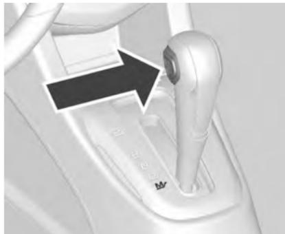
Переставьте рычаг переключателя в положение М.
