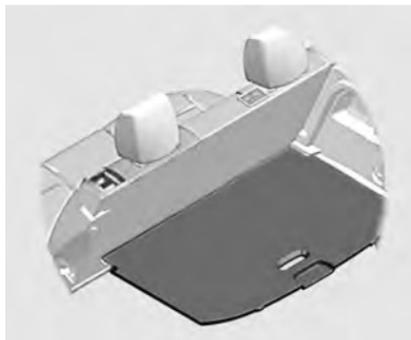
Если крышка багажного отделения поднята в верхнее положение, зафиксируйте ее в предусмотренном месте.
