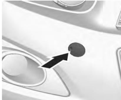
Отсоедините крышку, нажав на нее, и снимите.
