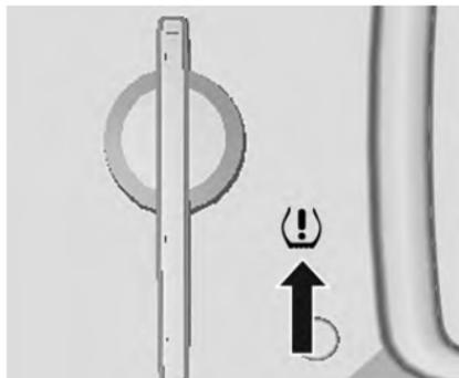
Если обнаруживается снижение давления в шинах, в комбинации приборов загорается индикатор (⚠).
