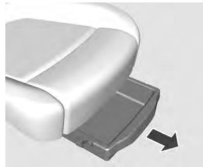
Для использования нижнего лотка сиденья переднего пассажира приподнимите конец лотка и потяните его в сторону приборной панели. Для возвращения лотка в исходное положение толкните его в сторону сиденья.
