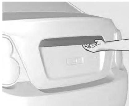
Чтобы открыть крышку багажника, отожмите ее и нажмите на нажимную панель.
