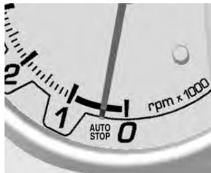
После остановки двигателя стрелка тахометра переместится в положение **AUTOSTOP**.
