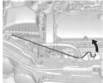
3. Слегка потяните из держателя вверх стержень опоры. Затем зацепите его за крючок в левой части отсека двигателя.
