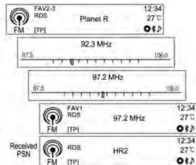
Для быстрого изменения частоты настройки нажмите и удерживайте одну из кнопок **SEEK**; дойдя до нужной частоты, отпустите кнопку.
