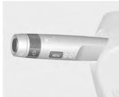
2. С помощью кнопки **MENU** и колесика регулировки на рычажке сигнала поворота выберите **Engine oil life** (Срок службы моторного масла) в информационном центре водителя.
