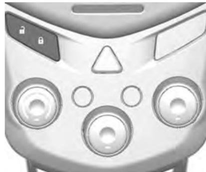
Запираение или отпирание всех дверей, задней двери (или крышки багажника) и крышки топливного бака.
