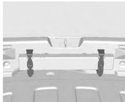
Знак аварийной остановки можно хранить на задней панели багажника, закрепив резиновыми лентами.
