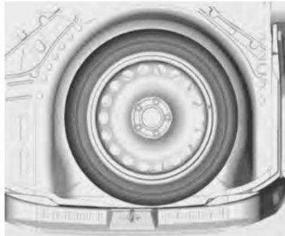
Запасное колесо хранится в багажном отделении под ковриком пола. Оно крепится в нише с помощью барашковой гайки.
