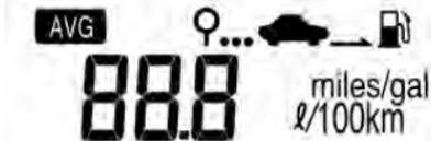
В этом режиме на дисплее отображается средний расход топлива.
