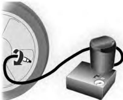
8. Отверните колпачок ниппеля поврежденной шины.
