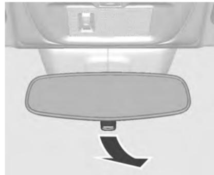
Для уменьшения бликов потяните рычаг на нижней части корпуса зеркала.
