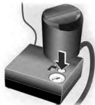
13. Рабочее давление в шине (около 2,4 бар) должно быть достигнуто примерно за 10 минут. По достижении нужного давления выключите компрессор.
