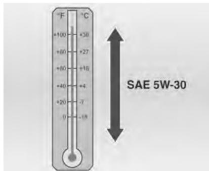
SAE 5W-30 - оптимальное значение вязкости масла для вашего автомобиля. Не используйте масла с другой вязкостью, например, SAE 10W-30, 10W-40 или 20W-50.
