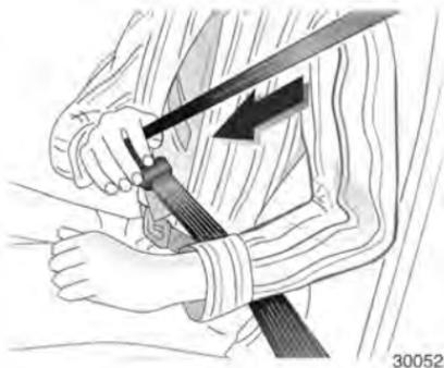
Извлеките ремень из катушки, протяните без перекручивания вдоль торса и вставьте язычок крепления в замок.
