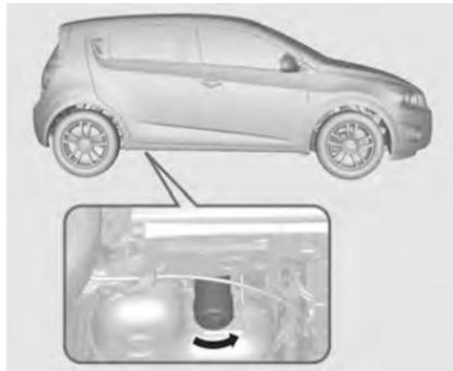
1. Найдите топливный фильтр рядом с топливным баком.
