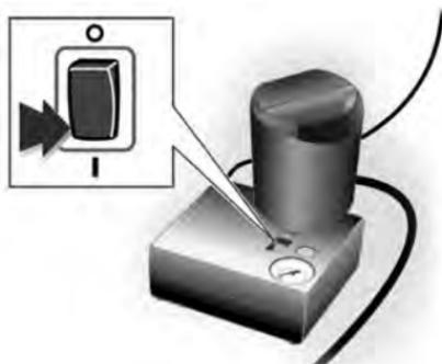
10. Установите клавишу выключателя компрессора в положение I. Шина заполнится герметиком.
