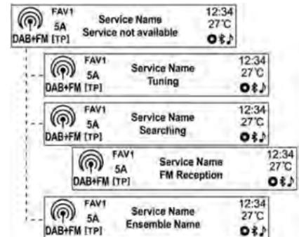
Если активирован режим **автосвязывания DAB-FM**, то при слабом сигнале DAB информационно-развлекательная система автоматически переходит на прием связанного компонента (см. **Settings (Настройки) → Radio settings (Настройки радио) → DAB settings (настройки DAB) → Auto linking DAB-FM (Автосвязывание DAB-FM)**).
