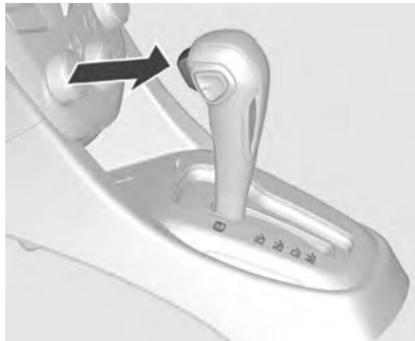
Для переключения между отдельными диапазонами передач необходимо нажимать кнопку разблокировки сбоку рычага переключателя.
