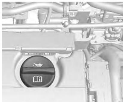
Крышка маслоналивной горловины двигателя находится на крышке распределителя.
