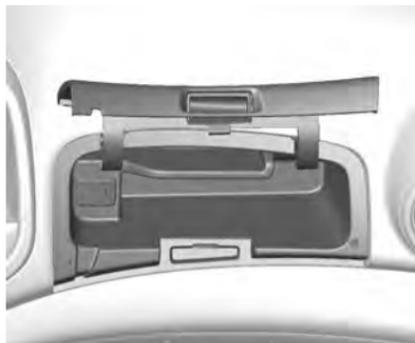
В отсеке для хранения над перчаточным ящиком имеются порты AUX, USB и др.
