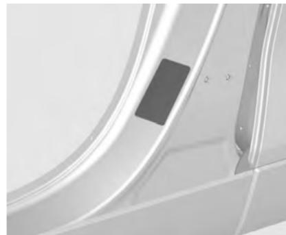
Наклейка с указанием давления в шинах на раме двери водителя.
