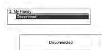
Для отсоединения подключенного устройства на экране со списком устройств поворотом ручки управления выберите подключенное устройство, выберите опцию **Disconnect** (Отсоединить) и нажмите кнопку **MENU**.
