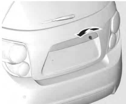
Для отпирания задней двери вставьте ключ в замочную скважину и поверните против часовой стрелки. Поднимите заднюю дверь.
