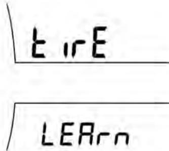
На этом экране производится определение параметров новых шин и колес датчиками системы TPMS.
