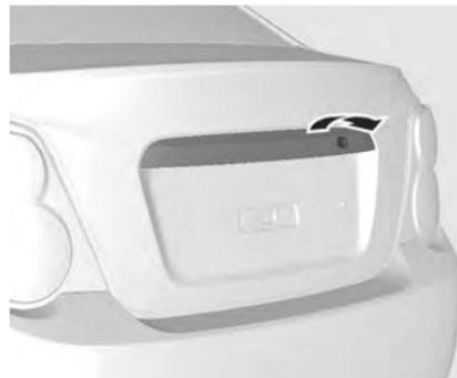
Для отпирания крышки багажника вставьте ключ в замочную скважину и поверните по часовой стрелке. Поднимите крышку багажника.
