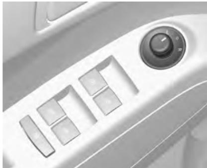
Выберите требуемое наружное зеркало поворотом переключателя влево (**L**) или вправо (**R**). После этого отрегулируйте положение зеркала, изменяя положение рычага выключателя.
