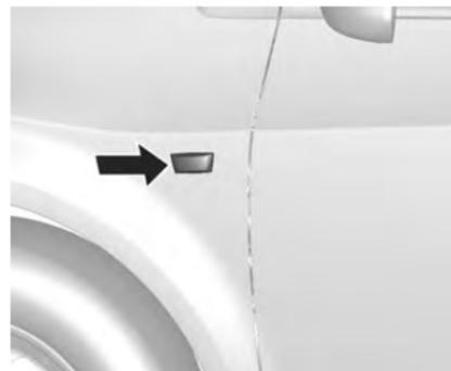
1. Извлеките фонарь с помощью отвертки. Сдвиньте фонарь вперед (на стороне водителя) или назад (на стороне пассажира). Затем отклоните фонарь вниз и выньте из углубления.
