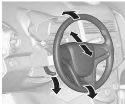
Освободите рычаг, отрегулируйте рулевое колесо, затем зафиксируйте рычаг и убедитесь, что он полностью заблокирован. Не регулируйте рулевое колесо до тех пор, пока автомобиль не будет остановлен.
