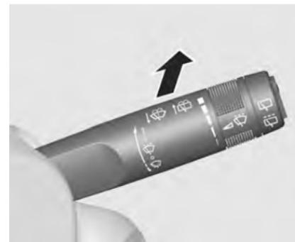
Сдвиньте рычажок в сторону панели приборов.
