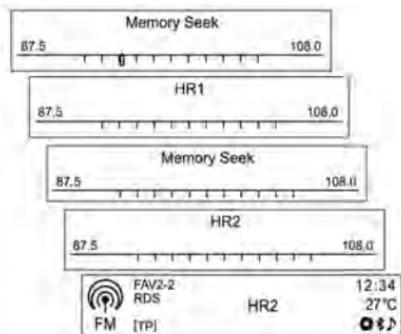
Нажмите одну из кнопок **SEEK** для автоматического поиска доступных радиостанций с хорошим приемом.
