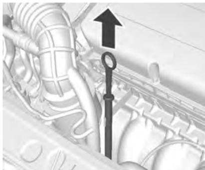
При снижении уровня моторного масла до отметки **MIN** долейте масло в двигатель.
