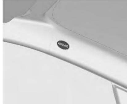
Система шторок безопасности включает подушки безопасности, установленные в раме крыши с каждой стороны. Эти подушки можно определить по надписи **AIRBAG** на стойках крыши.
