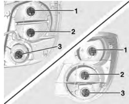
3. Задний габаритный фонарь / стоп-сигнал (1)
