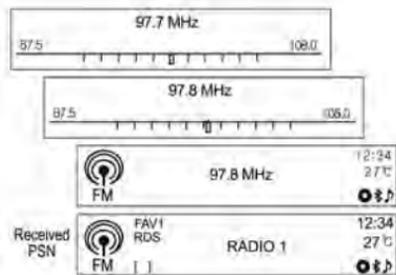
Поворотом ручки **TUNE** можно настраиваться на станции вручную.
