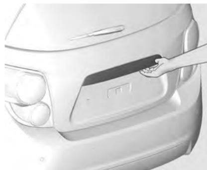
Чтобы открыть заднюю дверь, нажмите на нажимную панель, когда багажник отперт.
