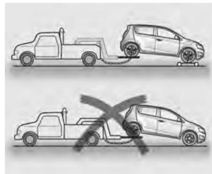
При буксировке с 2 поднятыми колесами, следует поднять передние ведущие колеса автомобиля и выполнять его буксировку с передними зафиксированными колесами.
