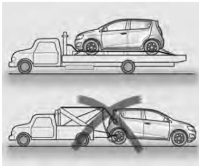
Наилучший способ транспортировки – использование автомобиля-эвакуатора с полной погрузкой.
