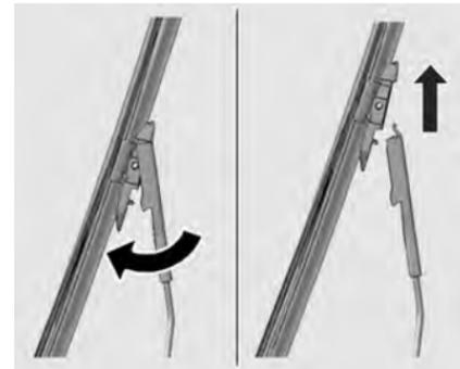
3. Вытолкните переднюю часть щетки стеклоочистителя, одновременно поворачивая ее, затем потяните ее вверх.
