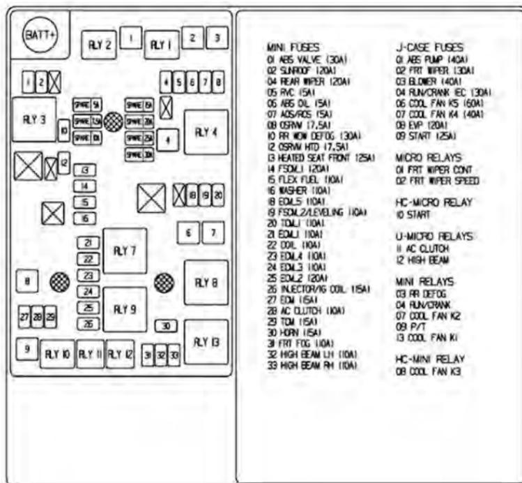
**Дополнительный блок предохранителей (1.4 турбо, бензин)**
