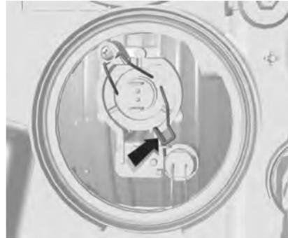
2. Нажмите на пружинный зажим и разъедините его.
