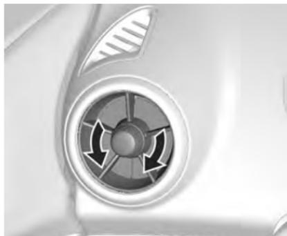
Чтобы открыть боковые вентиляционные отверстия, поверните ручку против часовой стрелки, затем поверните в нужном направлении.
