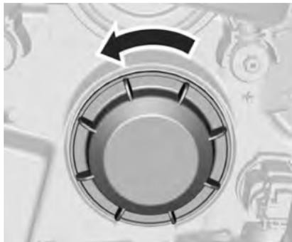
1. Снимите защитную крышку.
