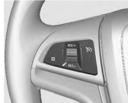
Система ограничения скорости позволяет установить максимальную скорость автомобиля. При превышении сохраненной максимальной скорости система информирует водителя световым индикатором или предупредительным звуковым сигналом.
