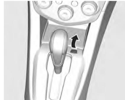
3. Снимите крышку на консоли с помощью тонкого предмета - например, плоской отвертки.
