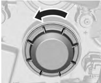
1. Снимите защитную крышку.
