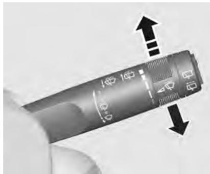
Для включения очистителя ветрового стекла поверните ключ зажигания во включенное положение и переведите вверх рычаг очистителя/омывателя ветрового стекла.
