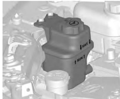
Уровень рабочей жидкости усилителя рулевого управления должен лежать между отметками **MIN** и **MAX**.
