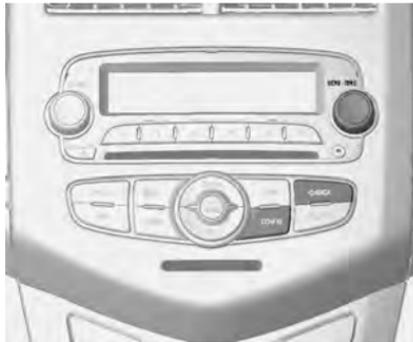
Нажмите на кнопку **CONFIG** при включенном зажигании и включенной информационно-развлекательной системе.
