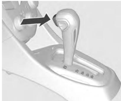
**P (СТОЯНКА):** Блокируются передние колеса. Переключайтесь в положение P только на стоящем автомобиле и при задействованном стояночном тормозе.
