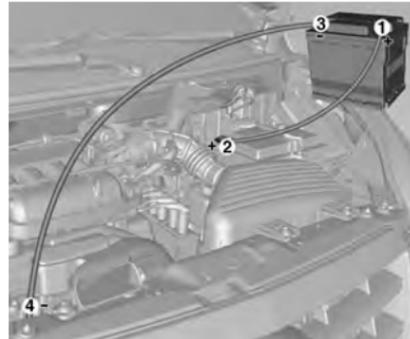
Порядок подключения проводов:
