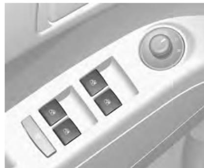
Электрические стеклоподъемники могут работать при включенном зажигании.
