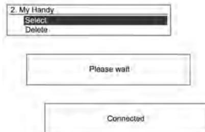
Для регистрации устройства выберите при помощи кнопки **MENU** и ручки управления **TUNE** пункт **Select (Выбрать)** и нажмите кнопку **MENU**; для удаления устройства выберите **Delete (Удалить)** и нажмите кнопку.
