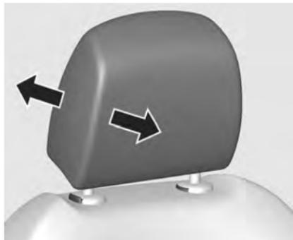
Вытяните подголовник вперед. Он имеет три положения регулировки. Чтобы отодвинуть подголовник назад, сдвиньте его вперед. После этого он отодвинется назад автоматически.
