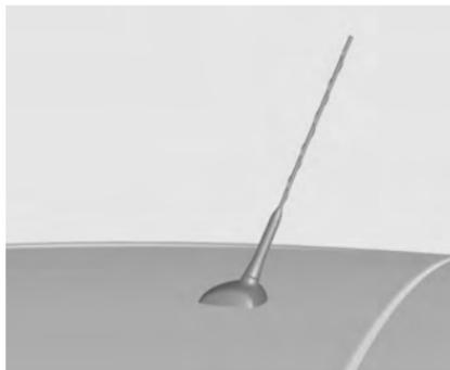
Для снятия вращайте антенну на крыше против часовой стрелки. Для установки вращайте антенну по часовой стрелке.
