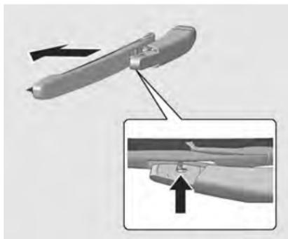
3. Снимите щетку с держателя вдоль направляющего выреза.
