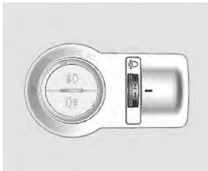
Корректировка угла наклона фар в соответствии с нагрузкой автомобиля для предупреждения ослепления: поверните ручку
