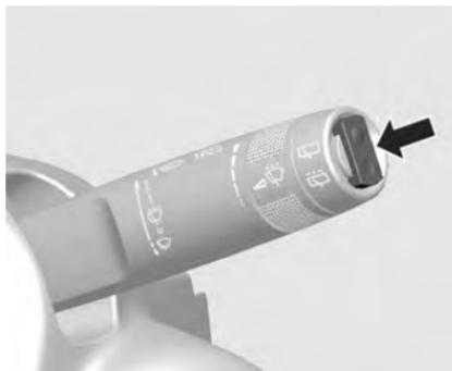
Для включения очистителя в непрерывном режиме нажмите на верхнюю часть переключателя.
