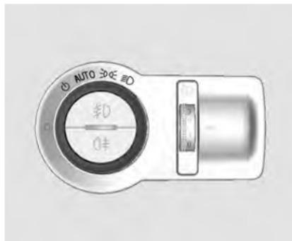
Для включения/выключения внешних световых приборов поверните ручку переключателя света. Переключатель света имеет четыре положения:
