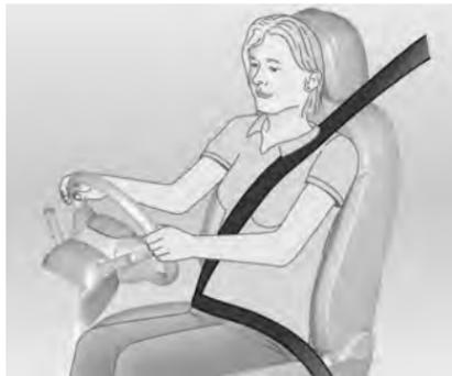
Снимите ремень с катушки, не допуская скручивания протяните вдоль тела и закрепите язычок замка в замке.
