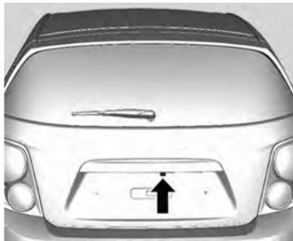
Камера находится в задней части автомобиля.
