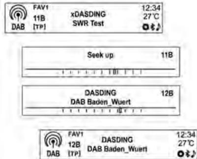
Нажмите кнопку **«SEEK»** для автоматического поиска доступных компонент службы DAB с хорошим приемом
