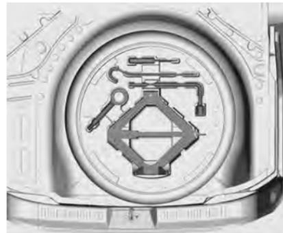
Домкрат и инструмент уложены в ящик в багажном отделении над запасным колесом.
