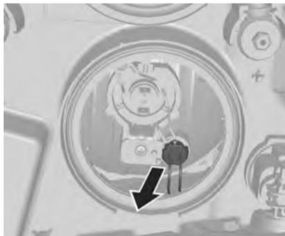
2. Выньте патрон лампы габаритного фонаря из отражателя.
