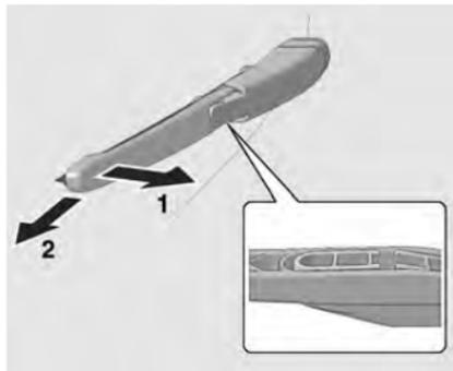
1. Поднимите щетку стеклоочистителя так, чтобы держатель рычага и щетка находились в одной плоскости.
