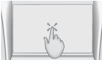
Данный жест используется при выборе кнопки или опции, для активации приложения или изменения местоположения на карте. Функция будет выполнена после отрыва пальца от экрана, а не при самом нажатии.
