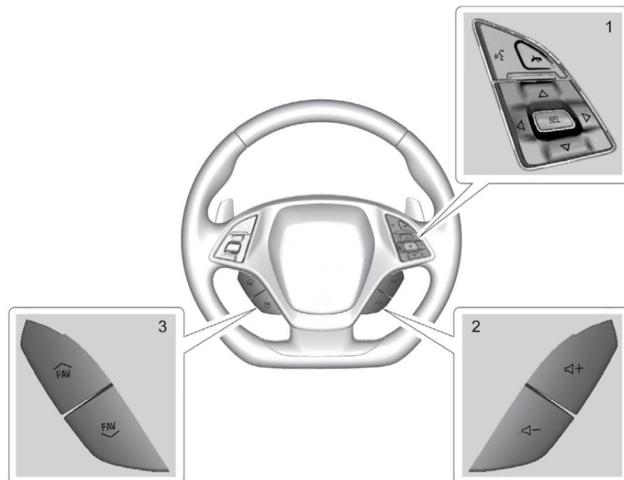
Определенными функциями аудиосистемы можно управлять с помощью кнопок управления на рулевом колесе.
